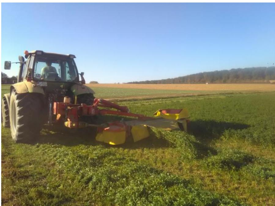
**Abbildung 2: Traktor mit Mähkombination mit integriertem Walzenaufbereiter.**
