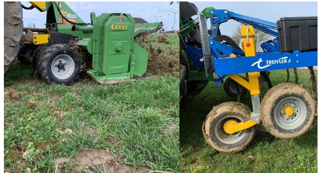
Bilder von A. Czech: Pendelachse der Celli-Fräse und Bogieachse des Treffler Grubber für eine optimale Boden Anpassung
