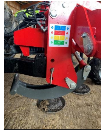
Bild von A. Czech: Bauliche Einrichtung an der 4Disc ActiCut für die Gewichtsübertragung vom Schlepper auf das Anbaugerät
